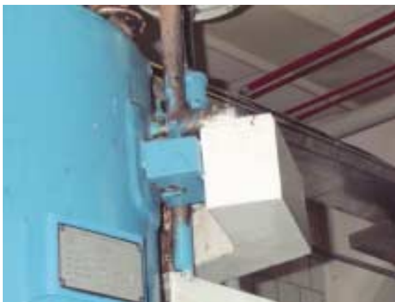
Рис. 9. Расположение тензодатчика весовой станции
