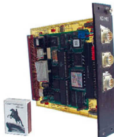
Рис. 6. Технологический образец модуля КС-МП в сборе, со снятой верхней фиксирующей крышкой
