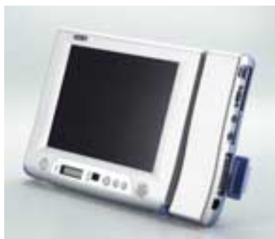
Gecis CA25 с установленным расширителем портов
